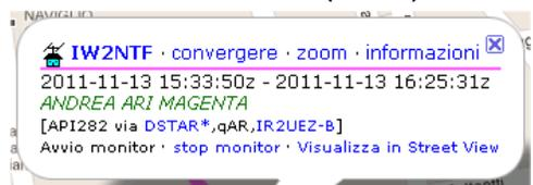
La differenza fondamentale delle due modalità **D-PRS**, è che la "**DVA**" (GPS-A) invia la stringa di dati compatibile esclusivamente con le applicazioni "internet" (tipo APRS.FI); la modalità "**DVG**" (GPS) invia la stringa di dati compatibile con internet e le altre radio D-STAR in frequenza, quindi le coordinate del GPS saranno visibili anche su radio remote tipo un altro IC 2820, ID 880 o IC 92, più o meno come avviene già con l'APRS e le radio tipo Kenwood TM D700, D710 o D72.
